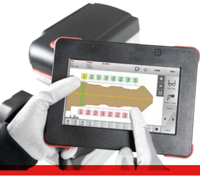
Máquina duplicadora de excelencia para llaves de coches láser, planas y Tibbe con código, con decodificación o con la introducción del cifrado, accionada por una innovadora consola móvil.
